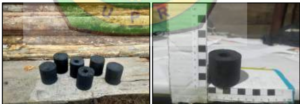
Gambar 4.21 Hasil Pencetakan Briket Arang
